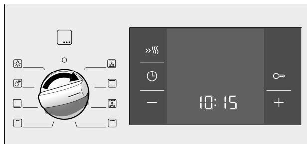
**2.** Задайте температуру или степень нагрева гриля с помощью регулятора температуры.
