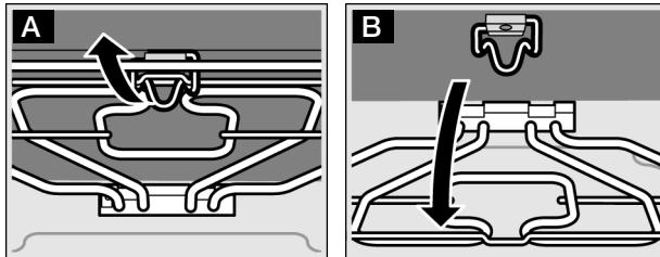
После окончания очистки снова закрепите нагревательный элемент гриля вверху. Нажмите на зажим гриля и вставьте нагревательный элемент на место.
