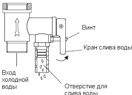
Во избежание поломки при завинчивании предохранительного клапана не применяйте больших усилий.
