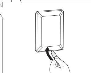
**1** С помощью отвертки снимите крышку.
