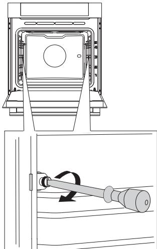
**1** Открутите винт с помощью отвертки.
