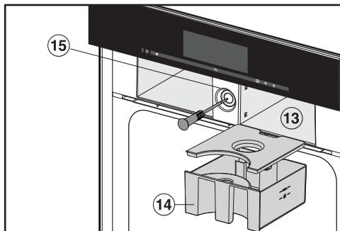
⑬ Отсек для емкости с водой
