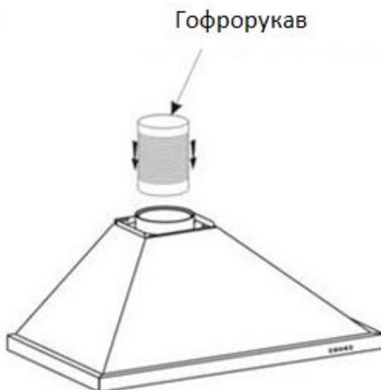
Закрепив крепежные скобы на стене, навесьте вытяжку, после чего соедините гофрорукав с вытяжным отверстием в стене. Предварительно места соединений гофрорукава рекомендуется промазать силиконовым герметиком.
