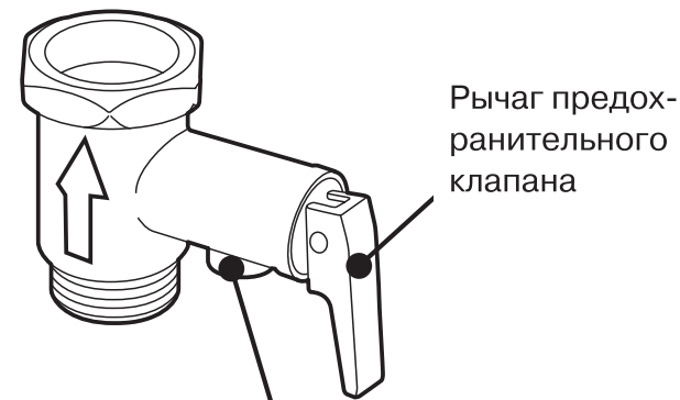
Выпускное отверстие предохранительного клапана
