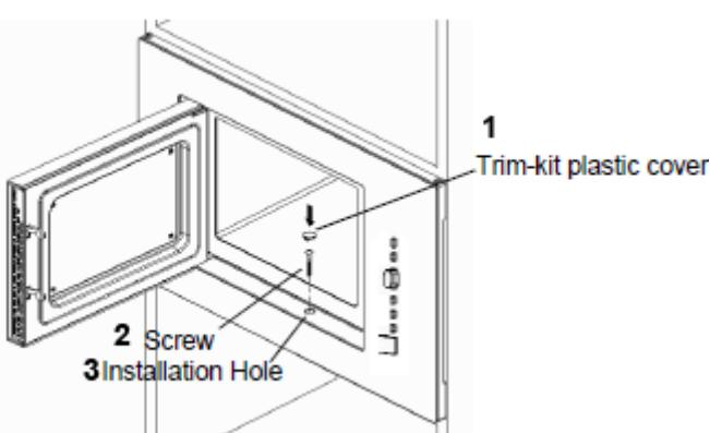
Откройте дверцу; закрепите прибор в шкафу винтом в монтажном отверстии. Затем в установочном отверстии (3) закрепите пластиковую крышку (1) винтом (2).
