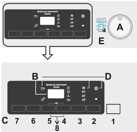
**A – Переключатель выбора программ:** Чтобы выбрать программу, вращайте переключатель в обоих направлениях. Отменить выбранную программу или выключить машину, вращайте ручку до положения OFF.
