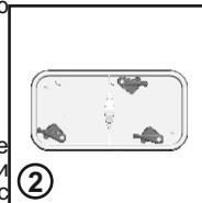
3. Осторожно извлеките рамку фильтра и уберите пыль с помощью ткани. Не используйте воду для очистки фильтра.
