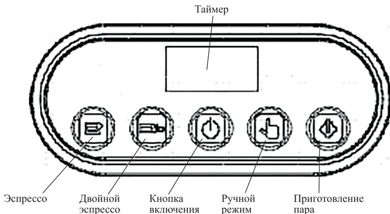
— кнопка подачи воды для порции эспрессо. Таймер по умолчанию установлен на 15 секунд.
