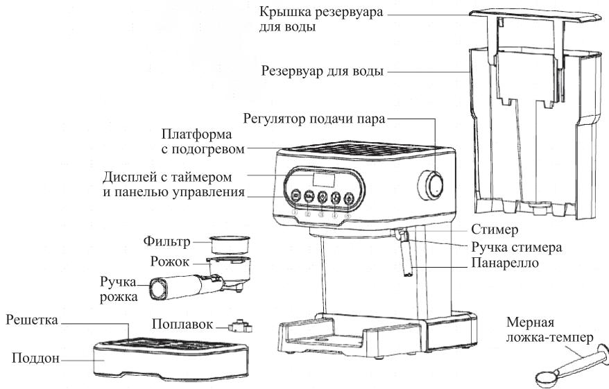
**Регулятор** подачи пара служит для включения и регулировки подачи пара через стимер. Будьте осторожны, после нагрева при первом включении стимера возможен выброс струи горячей воды под давлением, это происходит из-за скопления конденсата в стимере и является нормальным явлением. Подставьте стакан под углом к стимеру, чтобы струя воды не выплеснулась на руки.
