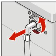
Снимите шланг со спинки прибора.
