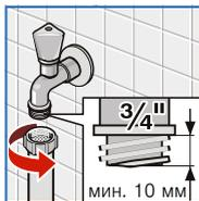
на водопроводном кране ( $\frac{3}{4}'' = 26,4 \text{ мм}$ ):
