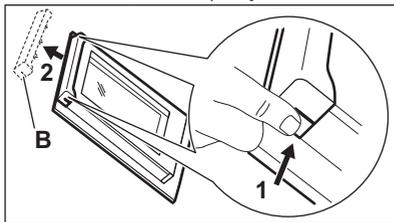
8. Чтобы снять дверную планку, потяните ее вперед.
