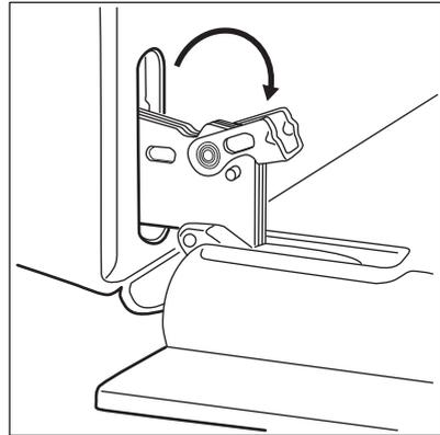
5. Прикройте дверцу наполовину до первого фиксируемого положения. Затем вытяните дверцу вверх и вперед из ее гнезда.
