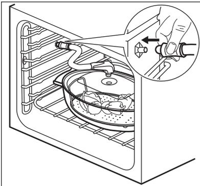
Убедитесь, что трубка форсунки не пережата и не касается нагревательного элемента в верхней части духового шкафа.
