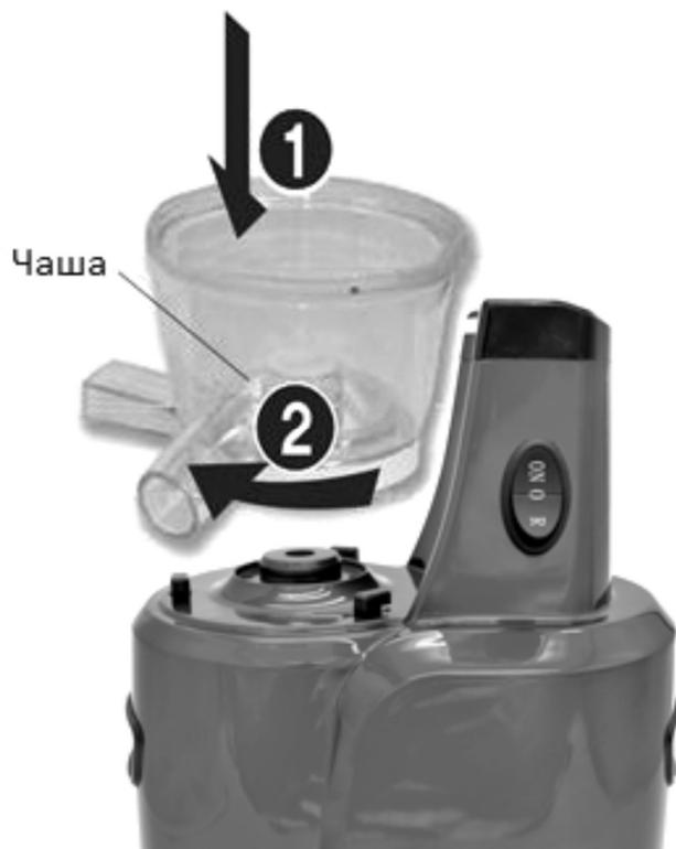
1. Поставьте устройство на ровную сухую поверхность. Установите чашу с отводами для сока и жмыха а корпус.
