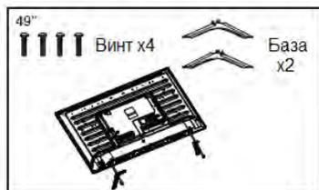
Когда вы зафиксируете двойную опорную базу на корпусе винтами, установка будет завершена.
