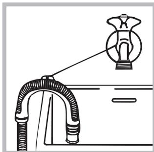
свързвайки доставения водач към крана (вж. фигурата). Свободният край на маркуча за мръсната вода не трябва да бъде потопен във водата.
