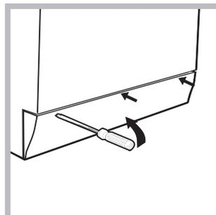
1. свалете панела в предната част на пералната машина с помощта на отвертка (виж фигура);
