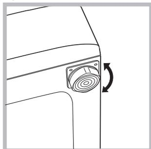
2. После установки машины на место отрегулируйте ее устойчивое положение путем вращения передних ножек (см. рис.). Для этого сначала ослабьте контргайку, после завершения
