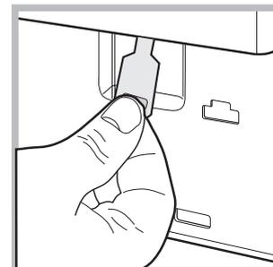
4. потяните наружу язычок, показанный на схеме, вплоть до освобождения пластикового блокировочного винта. Затем потяните его вниз и одновременно откройте люк.
