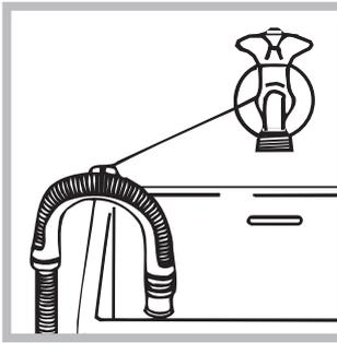
Buna alternatif olarak, makine ile birlikte verilen pis su borusunu musluğa (şekle bakınız) bağlayarak lavabo veya küvetin kenarına yerleştirin. Hortumun serbest kalan ucu suya daldırılmamalıdır.
