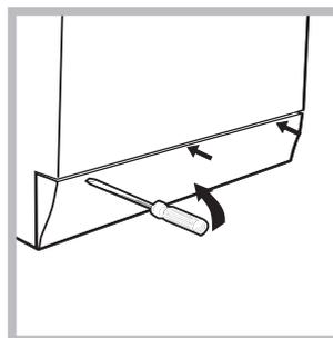
3. αφαιρέστε το ταμπλό κάλυψης στο πρόσθιο πλευρό του πλυντηρίου με τη βοήθεια ενός κατσαβιδιού (*βλέπε εικόνα*).
