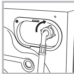
2. Su besleme hortumunu arka kısmının üst sağ köşesinde bulunan su girişine vidalayarak makineye bağlayınız (bkz. şekil).
