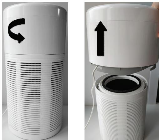
Извлеките блок фильтров из нижней части корпуса. Проверьте его на наличие загрязнений. Стряхните с блока фильтров всю скопившуюся пыль. Можно собирать всю крупную пыль пылесосом либо использовать пылесос на выдув. Не очищайте блок фильтров с помощью воды или иных жидкостей.
