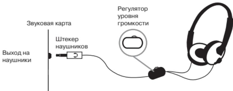
Рис. 1. Схема подключения
