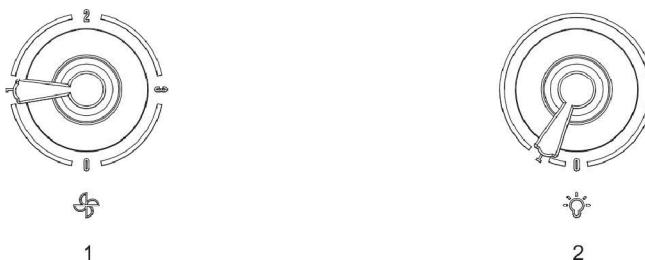
Работа вытяжки контролируется при помощи совмещенного переключателя
