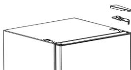
1. Снимите защитную крышку. Снимите верхнюю петлю.
