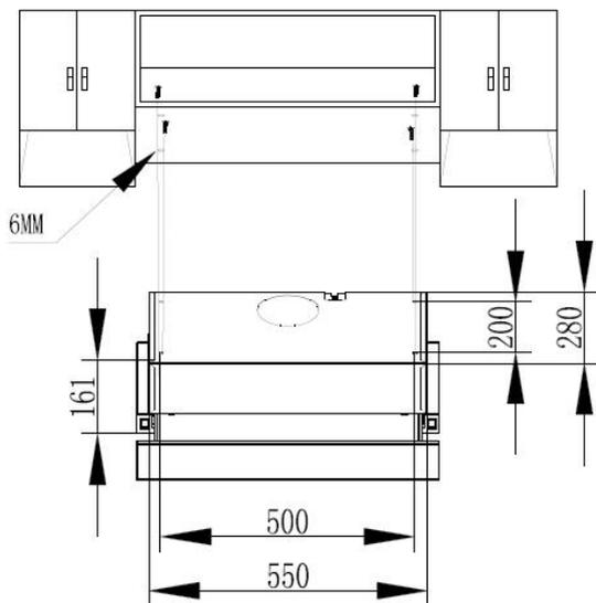
1. Просверлите 4 отверстия на 6 мм, внизу навесного шкафа в соответствии с отверстиями на задней стенке вытяжки.
