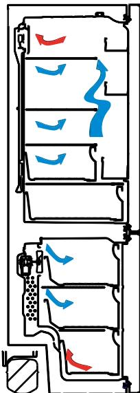
через отверстия в воздуховоде, за счет чего осуществляется охлаждение в холодильном отделении. Конструкция отверстий в воздуховоде обеспечивает равномерное распределение воздуха в этом отделении.
