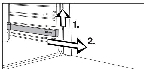
■ Приподнимите направляющую FlexiClip спереди (1.) и извлеките её вдоль опоры уровня (2.).
