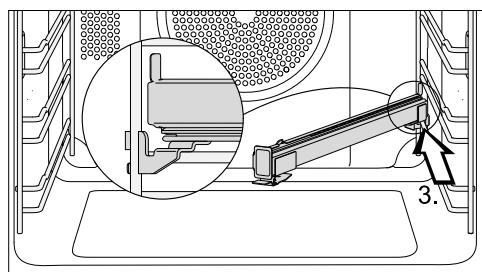
■ Сдвиньте телескопическую направляющую FlexiClip по диагонали вдоль верхней опоры назад до упора (3).
