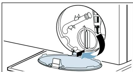
6. Закройте крышку отсека для сервисного обслуживания.
