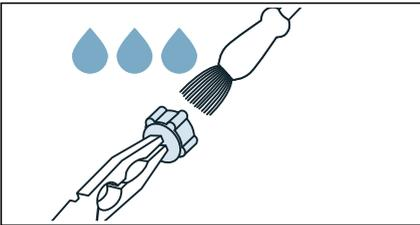
4. Подсоедините шланг и проверьте герметичность соединения.
