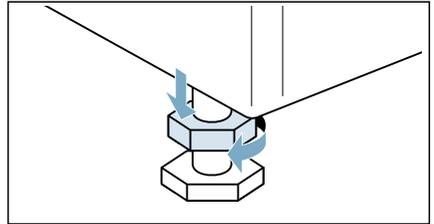
2. Проверьте выравнивание машины с помощью уровня. При необходимости скорректируйте. Измените высоту, повернув ножки машины. Все четыре ножки стиральной машины должны прочно стоять на полу.
