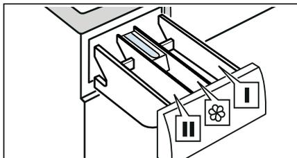
**Дозатор I** Моющее средство для предварительной обработки и дезинфицирующее средство для одежды. (только для машины с функцией предварительной стирки и дезинфекции)
