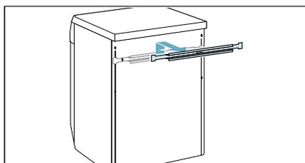
2. Снимите транспортировочные планки.
