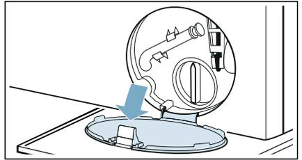
3. Выньте сливной шланг из держателя. Снимите колпачок и дайте воде стечь в подходящую емкость. Замените колпачок и поместите сливной шланг в держатель.
