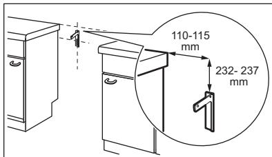
2. Отверстие для крепления находится слева на задней стороне прибора. Поднимите переднюю часть прибора и поместите его между кухонными шкафами. Если расстояние между кухонными шкафами больше, чем ширина прибора, следует установить его так, чтобы зазоры с обеих сторон были одинаковыми.
