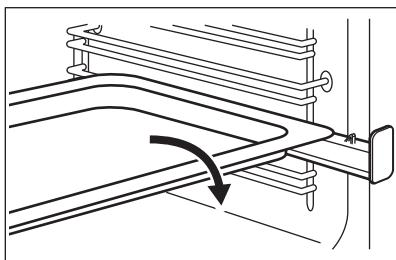
Одновременная установка решетки и противня для жарки:
