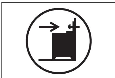
1. Установите кронштейн защиты от опрокидывания, воспользовавшись круглым отверстием в нем и отступив на 232-237 мм вниз от верхнего края прибора и на 110-115 мм от бокового края прибора. Как следует привинтите его к твердому надежному материалу или прикрепите с помощью соответствующей арматуры к стене.
