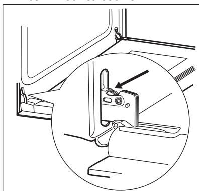
2. Поднимите и поверните рычажки на обеих петлях.
