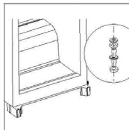
7. Отвинтите верхний шарнирный болт из петли, потом расположите петлю сверху и закрутите шарнирный болт.
