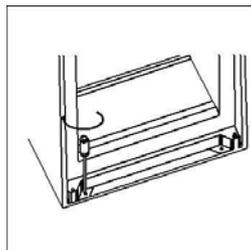
9. Привинтите верхний кронштейн к деревянной нише с помощью коротких шурупов.
