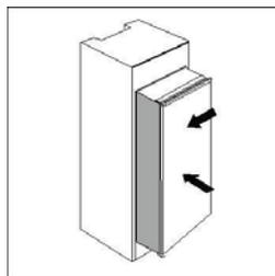
3. Ввинтите направляющую в отверстия двери с помощью коротких шурупов. Вставьте задвижку в направляющую и затем полностью откройте и закройте дверь холодильника и деревянную дверь для того, чтобы проверить, что деревянная дверь полностью закрывается.
