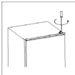
2. Отвинтите нижнюю петлю двери морозильного отделения. Снимите дверь и положите на мягкую поверхность, чтобы избежать царапин на поверхности дверцы.
