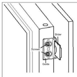
4. Откройте дверь холодильника и деревянную дверь и отметьте позицию задвижки, в которой задвижка может нормально функционировать под любым углом, когда дверь открывается или закрывается. Вытащите задвижку из направляющей и прикрутите направляющую к деревянной двери с помощью двух коротких шурупов. Затем зафиксируйте крышку задвижки на задвижке.
