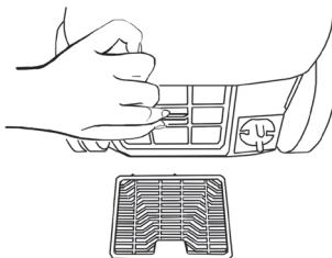
Извлеките фильтр. Промойте его прохладной водой под краном. Запрещается мыть фильтр горячей водой или использовать для его мытья моющие средства.
