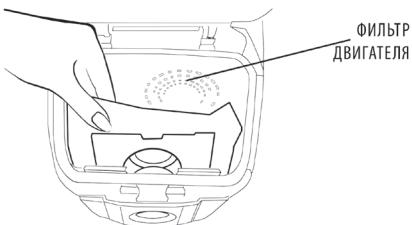
Промойте фильтр прохладной водой под краном. Запрещается мыть фильтр горячей водой или использовать для его мытья моющие средства.
