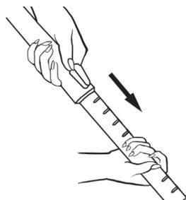
3 Отрегулируйте длину телескопической трубки.
