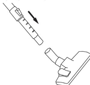
4 Установите на трубку подходящую насадку.
