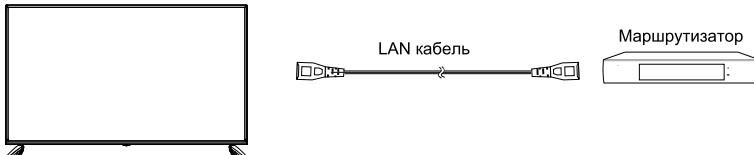
Подключите LAN кабель со штекером RJ-45 к разъему LAN на задней стороне телевизора. Это необходимо для работы SMART режима ТВ в режиме проводной интернет-сети.
