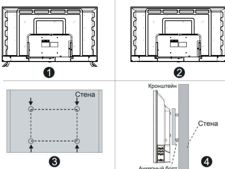
1. Положите телевизор экраном вниз на мягкую поверхность, чтобы предотвратить его повреждение.
