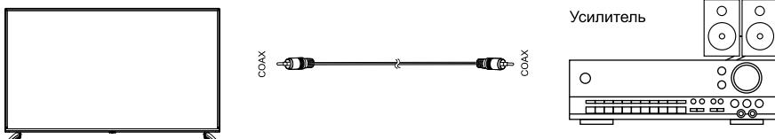
Только для ЦТВ или HDMI источника сигнала. Подключите коаксиальный вход внешней аудиосистемы к соответствующему выходу телевизора. Коаксиальный выход телевизора обеспечит вам наиболее качественную передачу звука на внешнюю аудиосистему без искажений.
