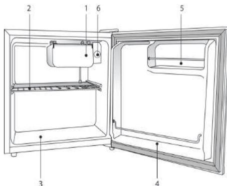
1. Отделение для приготовления кубиков льда и быстрого охлаждения напитков. (Не предназначено для замораживания свежих продуктов и хранения замороженной пищи).
