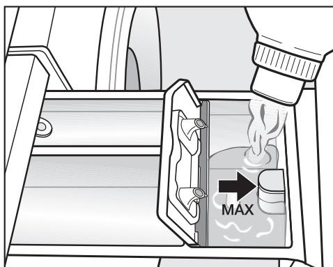
■ Наполните кондиционером, добавкой для придания формы или жидким крахмалом ячейку . **Не превышайте максимальную высоту наполнения.**
