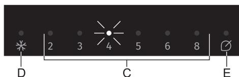
Если температура внутри прибора превышает допустимое значение, включается прерывистый звуковой сигнал и мигает индикатор (С) над установленной температурой.
