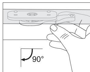
**3** Чтобы разблокировать замок, откройте дверцу духовки и указательным пальцем потяните замок на себя. Замок дверцы разблокирован (в рабочем состоянии).
