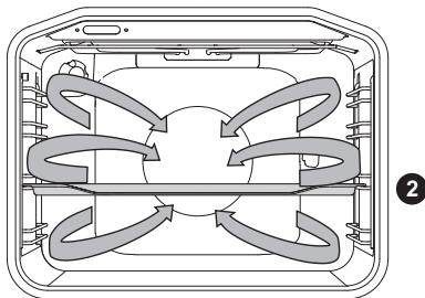
Одновременно работают нагревательный элемент вокруг вентилятора и вентилятор. Вентилятор создает постоянную циркуляцию горячего воздуха вокруг мяса или выпечки.
