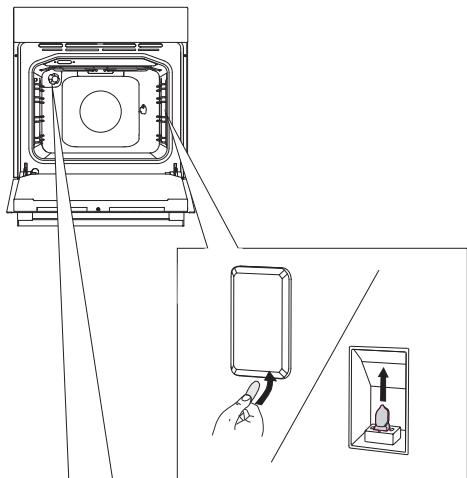
С помощью отвертки подденьте и снимите крышку. Замените лампочку.
