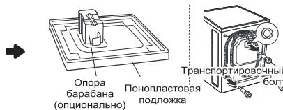
Снимите транспортировочные болты и опоры.
