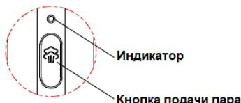
4. Нажмите кнопку подачи пара и приступайте к отпариванию. Во время отпаривания индикатор всегда должен гореть зеленым. Встроенный термостат циклически включается и выключается, поддерживая определенную температуру, из-за этого пара может быть то незначительно больше, то незначительно меньше.
