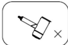
Не кладите работающий прибор резервуаром для воды вниз, т.к. в этом случае вода перестанет поступать на нагревательный элемент, подача пара прекратится, а вода может вытечь, что может привести к поражению электрическим током.
