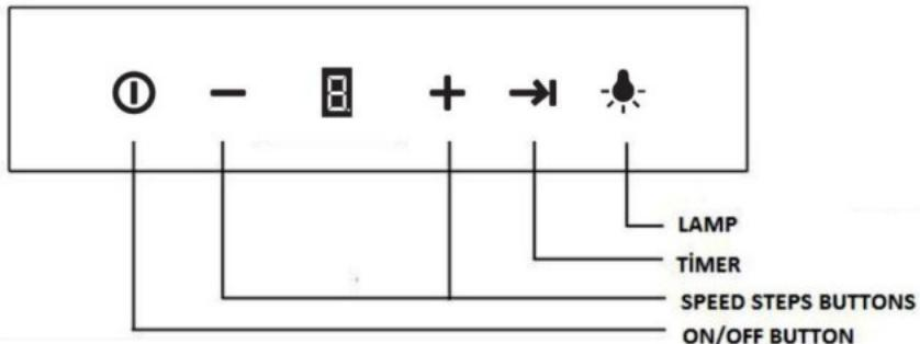
**On/Off button - Кнопка On/Off:** Прикосновение к этой области повернет заслонку в первое положение при включении изделия, и изделие начнет работать на 2-м уровне скорости. Нажмите эту кнопку, чтобы выключить продукт во время его работы.
