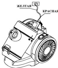
1. Возмитесь за вилку питания и вытяните шнур питания до желтой отметки. Не вытягивайте шнур питания далее красной отметки.
