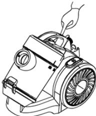
Нажмите на кнопку фиксации контейнера для сбора пыли и снимите его с пылесоса.
