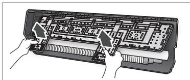
3. Определите положение отверстия для трубки и сливного шланга как показано на рисунке, и просверлите отверстие внутренним диаметром 65 мм так, чтобы оно слегка наклонялось вниз.
