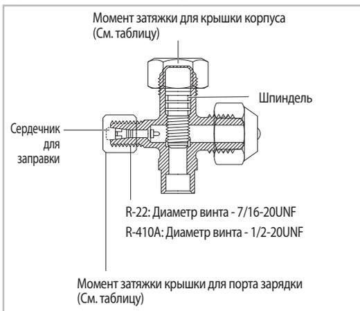
**Чтобы проверить отсутствие утечек газа на наружном блоке,**
