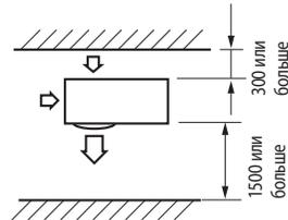
**При установке более одного (1) наружного блока**
