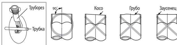
3. Чтобы предотвратить утечку газа, удалите все заусенцы со среза трубы с помощью развертки.
