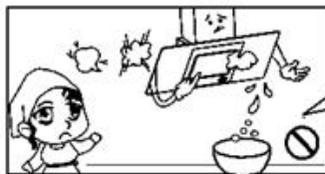
Никогда не мойте блок управления водой или другими жидкостями во избежание электрических неисправностей, которые может повлечь попадание жидкости в панель.
