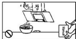
Очищайте вытяжку правильно, согласно инструкции, в противном случае появляется риск возгорания.
