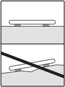
(RUS) Установить весы на прочную ровную поверхность.
