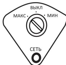
Температура регулируется путем поворота терmostата в соответствующие положение (от MIN к MAX).
