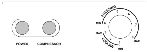
При подключении к электросети загорается индикатор **Power** (зеленый). Индикатор **Compressor** (красный) на панели управления означает, что включен и работает компрессор.
