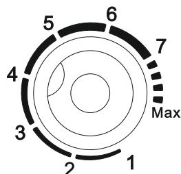
Для использования функции быстрой заморозки установите термостат в максимальное положение за 4-8 часов до укладки в ларь продуктов для достижения наименьшей температуры.
