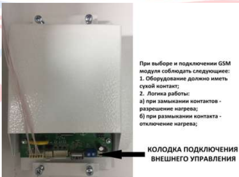
Рисунок 8. Подключение GSM модуля к электродотлу РЭКО серии П
