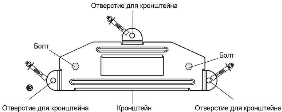
Установка прибора на кронштейн
