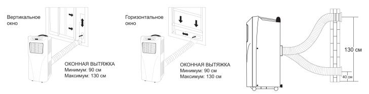
Оконная вытяжка была разработана с учетом конфигурации большинства стандартных горизонтальных и вертикальных оконных конструкций. Тем не менее, может понадобиться усовершенствование некоторых процедур установки для нестандартных окон.
