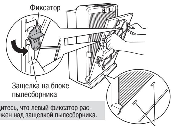
Два отверстия на корпусе устройства.
