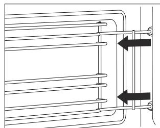
**1** Открутите винты с помощью отвертки.
