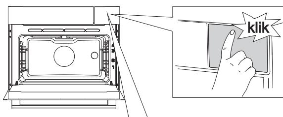
**1** Откройте крышку отсека резервуара, нажав на нее.
