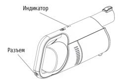
Штекер адаптера питания подключите к соответствующему разъему на корпусе пылесоса. Вилку питания адаптера питания подключите к электрической розетке.
