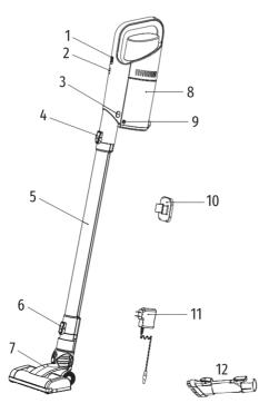
1. **О** Кнопка включения/выключения и изменения мощности
