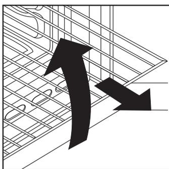
Piekarnik wyposażony jest w nowy system blokady rusztów. System ten pozwala na niemal całkowite wysunięcie rusztów, bez groźby wypadnięcia ich z piekarnika, z jednoczesnym utrzymaniem ich pozycji poziomej, umożliwiając w ten sposób sprawdzenie i wymieszanie potrawy w sposób jak najbardziej pewny i cichy. Aby wyciągnąć ruszt, wystarczy, jak wskazuje rysunek, unieść je, chwytając za przednią część i pociągnąć w swoim kierunku.
