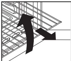
Духовой шкаф оборудован системой безопасности полок. Она позволяет выдвигать полки для проверки блюда без риска его соскальзывания или случайного выпадения полки из духового шкафа. Чтобы полностью вынуть полку потяните её к себе и вверх.
