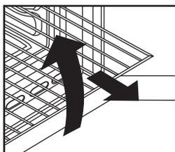
Il forno é dotato di un nuovo sistema di arresto griglie. Questo sistema consente di estrarre le griglie quasi completamente senza che queste fuoriescano dal forno mantenendole perfettamente in piano, consentendo di verificare e mescolare il cibo con la massima tranquillità e sicurezza.
