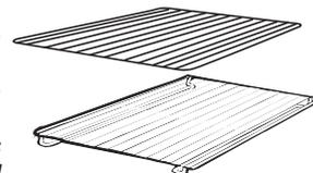
O tabuleiro buleiro de recolha de sucos serve para aparar o suco dos grelhados. Pode ser colocado por cima da grelha ou introduzido nas calhas. Só se utiliza com o Grelhador, o Espeto ou o Turbogrelhador. Nos outros modos de cozedura deve ser retirado do forno. Nunca utilizar este tabuleiro como recipiente para assar, pois causaria salpicos de gordura e fumos, e rapidamente sujaria o forno.
