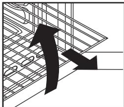
Deze oven is uitgerust met een nieuw veiligheidssysteem voor het uittrekken van de roosters. Dit systeem stelt u in staat om de roosters naar voren te trekken zonder het gevaar op te lopen, dat het rooster of het bereide voedsel per ongeluk uit de oven vallen. Om de roosters uit de oven te halen, dient u deze naar voren te trekken en lets op te tillen
