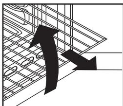
El horno está dotado de un nuevo sistema de sujeción de las rejillas. Este sistema permite extraer las rejillas casi por completo sin que caigan y manteniéndolas perfectamente en plano, permitiendo verificar y mezclar los alimentos con la máxima tranquilidad y seguridad.
