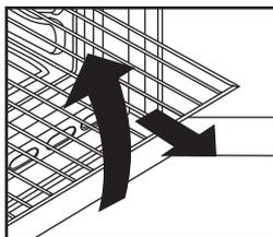
Tous les fours bénéficient d'un nouveau système d'arrêt des grilles. Ce système permet de sortir complètement la grille en totale sécurité. Parfaitement bloquée elle ne peut pas basculer vers l'avant malgré la présence d'un poids important. Plus stables, ces grilles assurent une plus grande sécurité et tranquillité.
