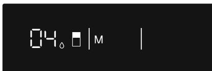
Нажмите и удерживайте кнопку настройки холодильного отделения (№ 4 на схеме панели управления), пока на дисплее не появится символ интенсивного охлаждения (№ 3). Раздастся звуковой сигнал. Режим будет установлен.
