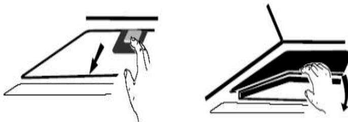
Установите угольный фильтр на моторе и поверните по часовой стрелке для закрепления. То же самое сделайте с другой стороны мотора.
